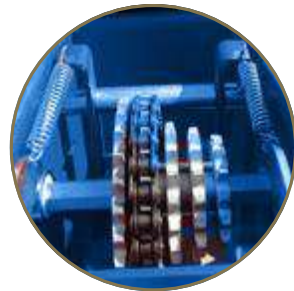
Geniş aralıkta ayarlanabilen transmisyon sistemi
